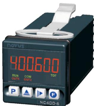
Contador electrónico de 6 dígitos con función de contar, totalizar y contador de lotes. Permite conteo en cuadratura y cuenta con entrada para reset remoto. Sus 2 salidas con accionamiento temporizado pueden ser accionadas en los 2 presets de conteo, de lote o totalizador. Posee una tecla con función programable, factor de escala ajustable y diversas otras opciones avanzadas configuración.
