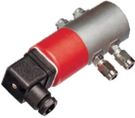
Los transmisores de presión diferencial de la serie **692** miden con alta precisión presiones diferenciales de 0 a 0,1 bar hasta 0 a 25 bar con gran resistencia a sobrepresiones unilaterales.
