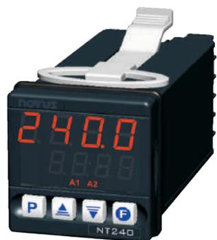
Con 4 dígitos, ofrece al usuario una salida de control que es accionada de acuerdo con once tipos de temporizaciones posibles. Cuenta con entradas digitales que ejecutan funciones tales como: start, hold y reset. La pantalla muestra el conteo del tiempo.
